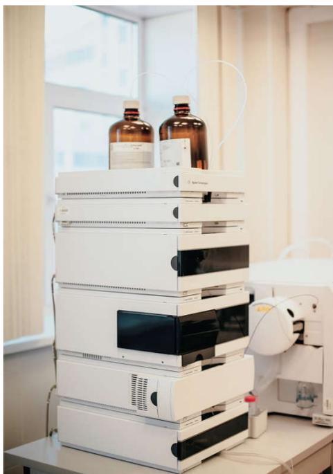
Рис. 1. Высокоскоростной жидкостный хроматограф «1200» («Agilent Technologies», США) с диодно-матричным детектором.
