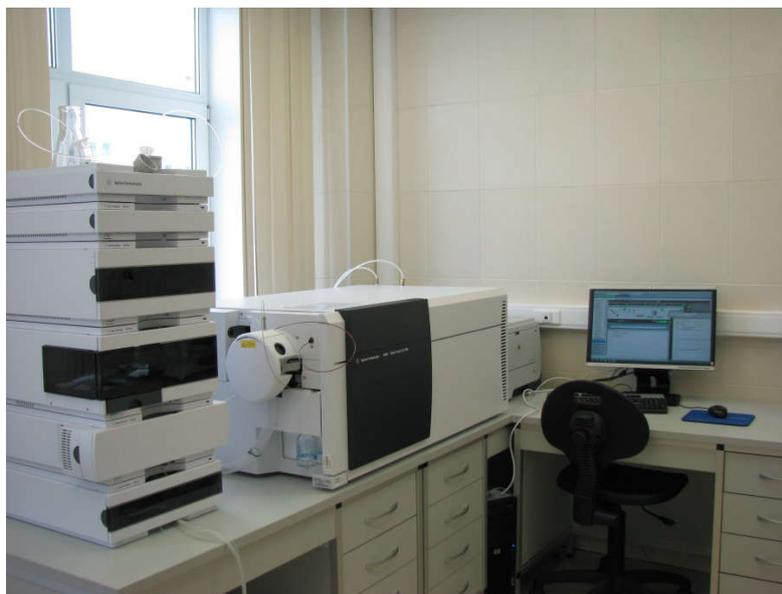
Рис. 3. Высокоэффективный жидкостный хроматограф «Agilent 1200» с диодноматричным детектором и масс-спектрометром с тройным квадруполем «Agilent 6400» (Agilent Technologies, США).
