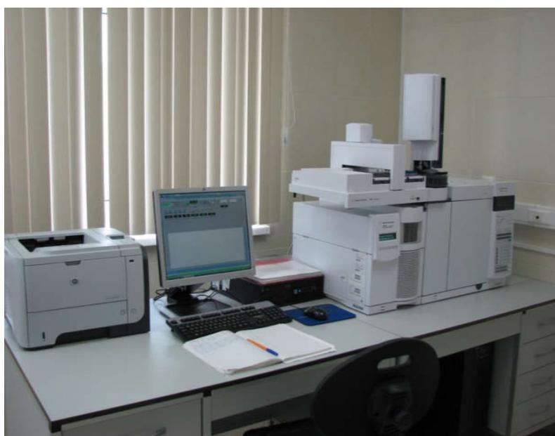
Рис. 7. Газовый хроматограф «Agilent 7890» с масс-селективным детектором («Agilent Technologies», США).
