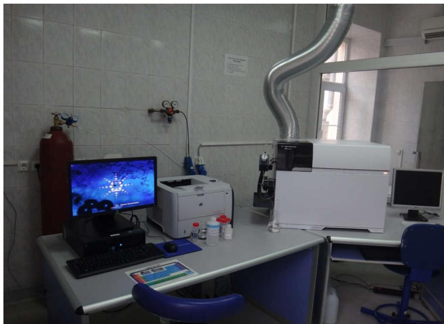
Рис. 9. Рабочая зона для микроэлементного анализа готовых биопроб с помощью масс-спектрометра с индуктивно связанной плазмой «Agilent 7900» («Agilent Technologies», США).
