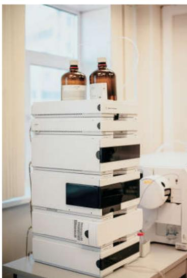
Рис. 4. Высокоэффективный жидкостный хроматограф «1200» (Agilent Technologies, США) с диодно-матричным детектором.
