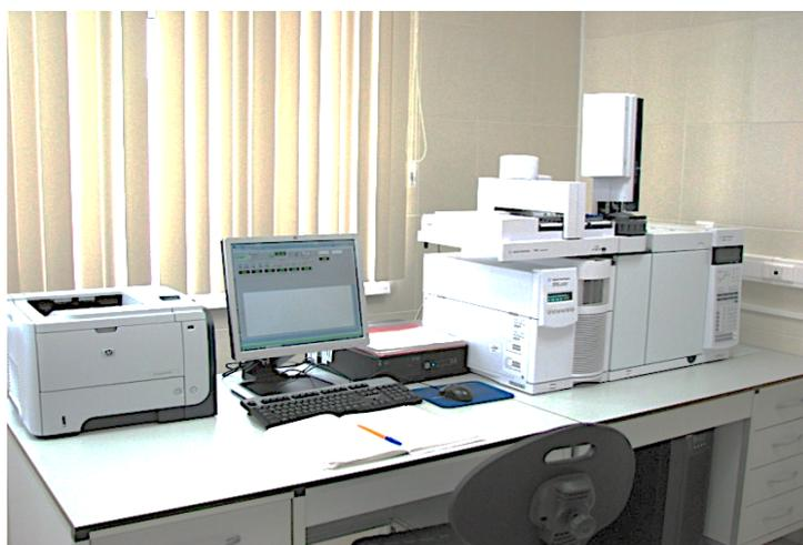
Рис. 5. Газовый хроматограф «Agilent 7890» с масс-селективным детектором («Agilent Technologies», США).
